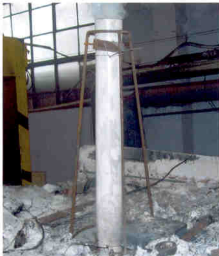
照片 1 耐火試驗前試件情況 本函件未經公司章 及影印，皆屬無效。
