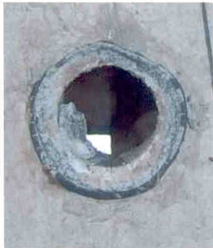
照片 1 耐火試驗前試件情況 本函件未經公司章 及影印，皆屬無效。
